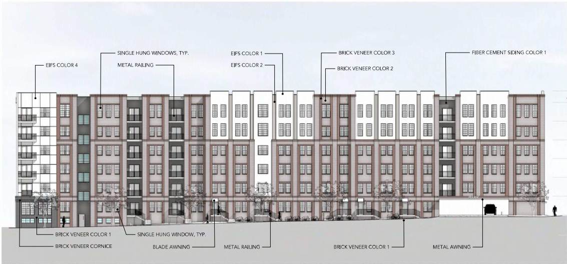
NORTH ELEVATION (WASHINGTON STREET)
